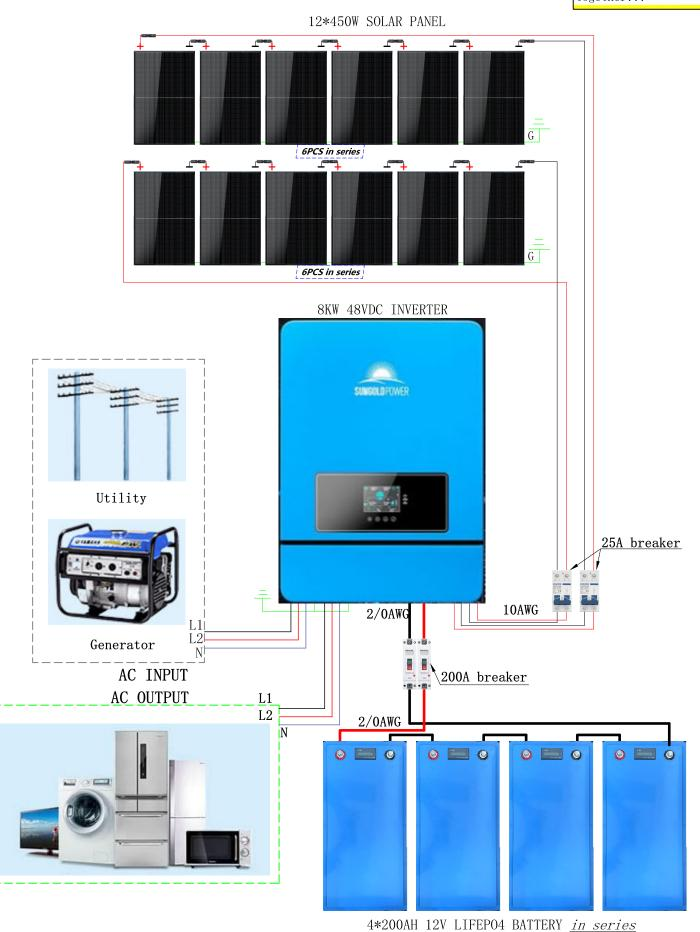
COMPLETE OFF-GRID SOLAR KIT 8000W 48V 120V/240V OUTPUT 10. 24KWH LITHIUM BATTERY 5400 WATTS (450W\*12PCS) SOLAR PANELS
